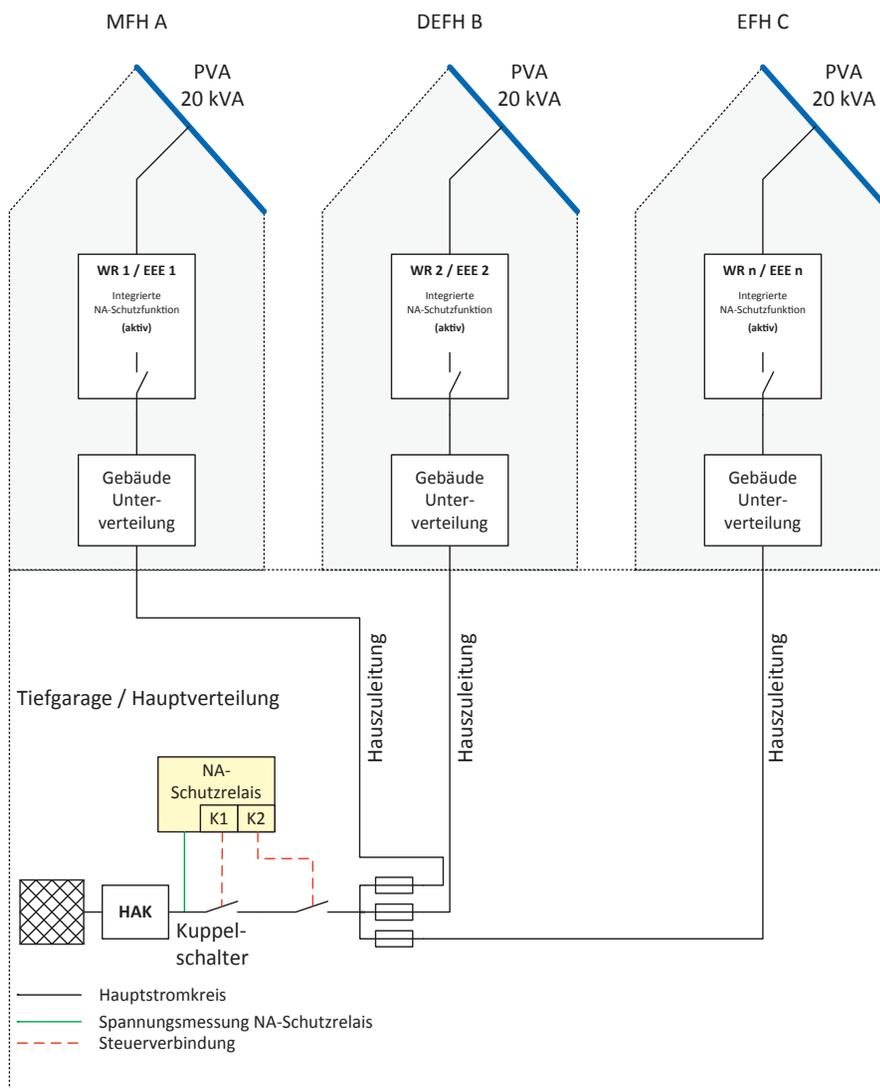
Abbildung 7: Quartierlösung mit zentralem NA-Schutz und zwei Kuppelschaltern
