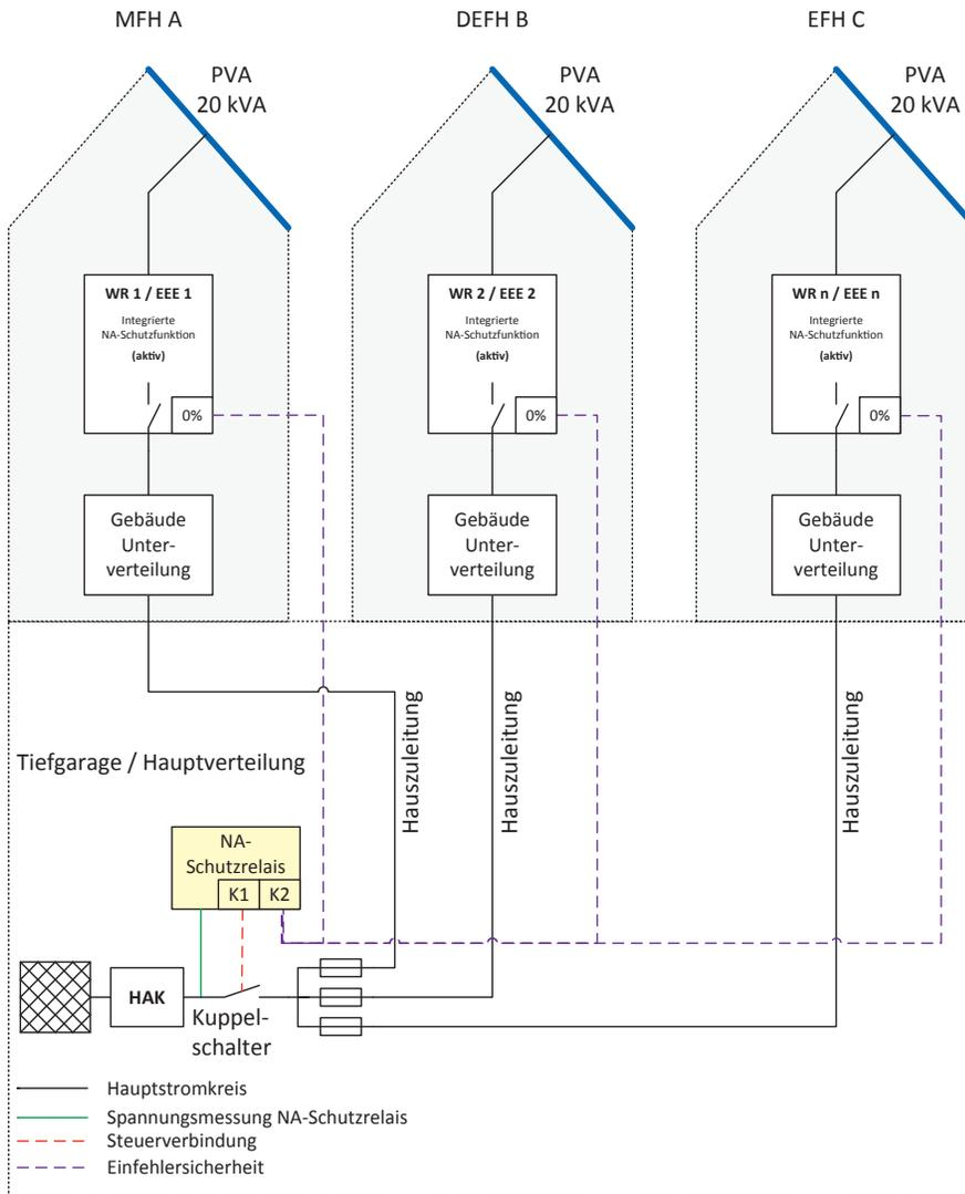
Abbildung 8: Quartierlösung mit zentralem NA-Schutzrelais und Einfehlersicherheit
