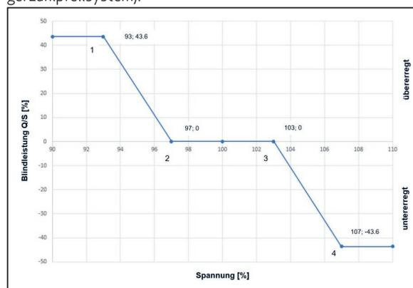
Abb. 1: Q(U)-Kennlinie im Erzeugerzählpeilsystem
