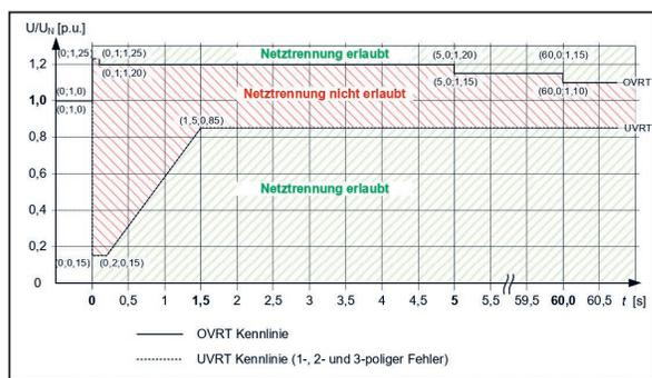
Abb. 4: u(t)-Kennlinie von EEA Typ 2 > 3,6 kVA
