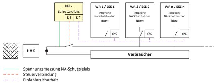
Abbildung 2: Spezialfall mit nur einem WR
