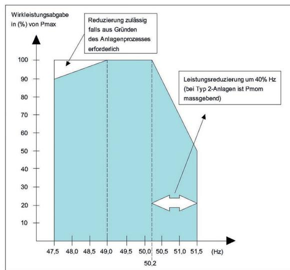
Abb. 6: Wirkleistungsabgaben in Abhängigkeit von der Netzfrequenz
