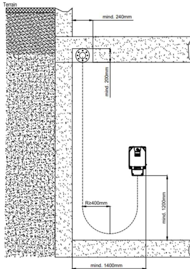
Grundsätzlich ist von einer Einführung über die Deckenplatte abzusehen. Nur möglich in den anschließenden (Technik-) Raum an der Aussenwand. Dies nur nach Rücksprache mit dem zuständigen AEW Regional- Center.
